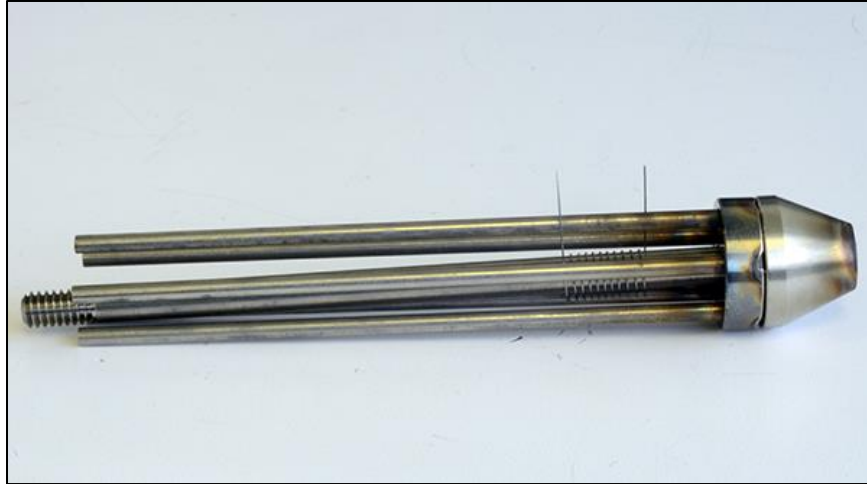
Figura 12 – Tornillo de varilla insertado a través de la abertura de la jaula de protección
