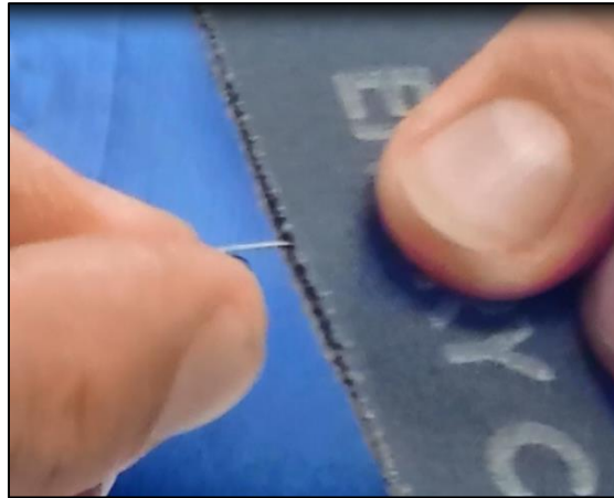
Figura 12 - Uso de un paño de esmerilado en una bobina de alambre
