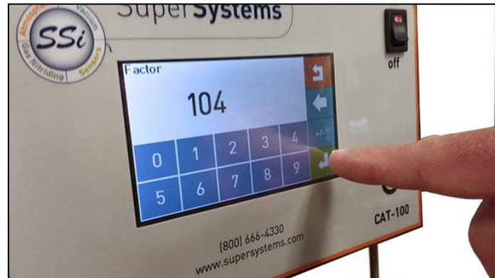
Figura 5 – Introducir un nuevo factor de bobina
