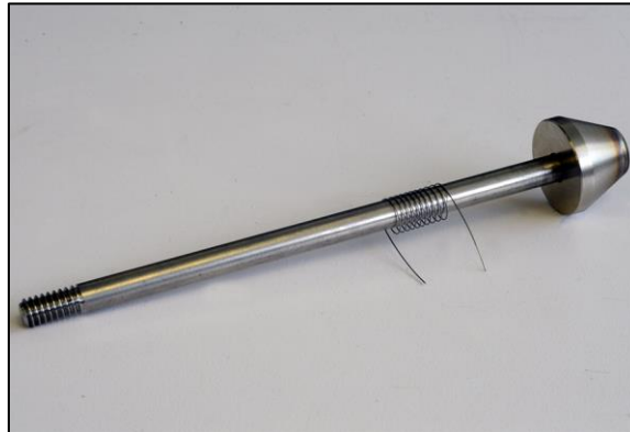
Figura 11 - Bobina de alambre colocada en el tornillo de la varilla
