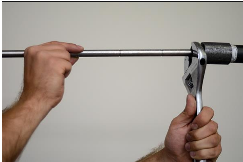
Figura 10 - Apriete del conector del puerto con la llave
