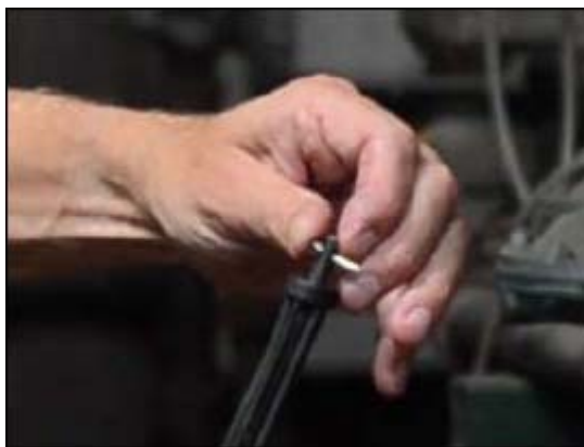
圖 6：插入開口銷穿過孔取樣棒的孔
