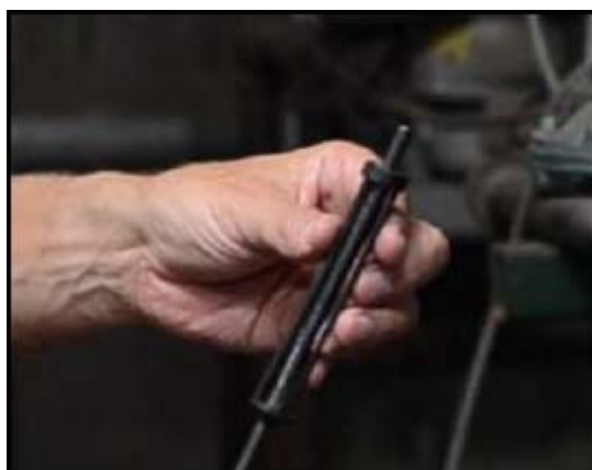
圖 5：保護罩裝在取樣棒上
