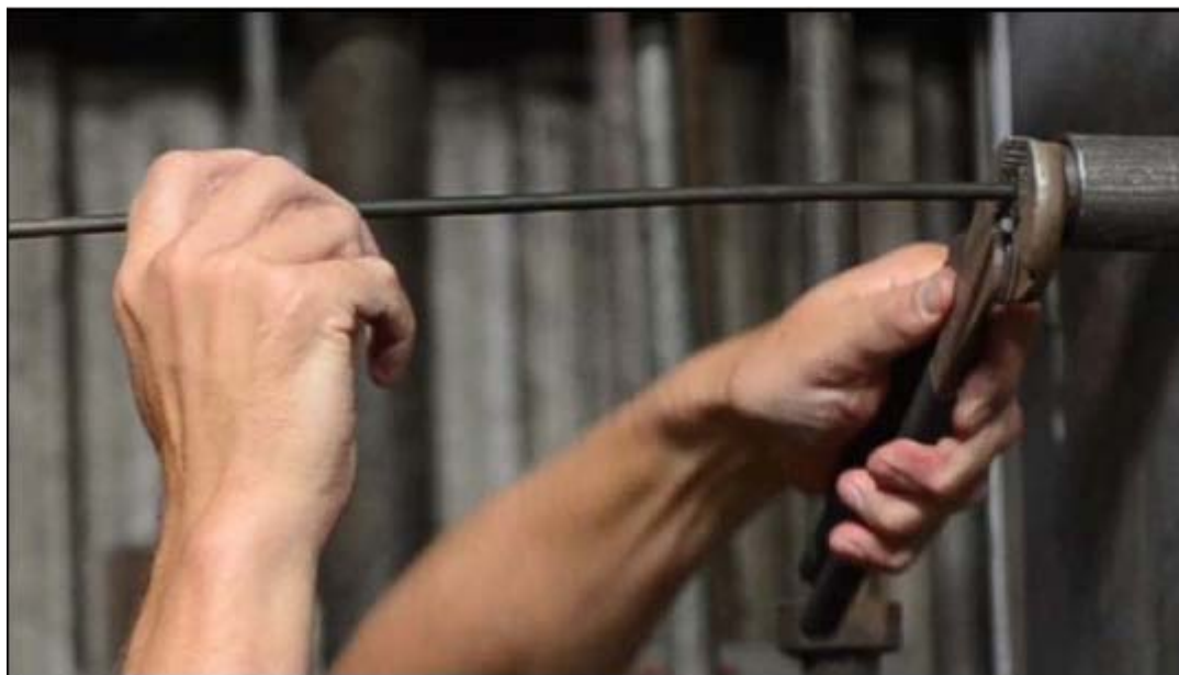
圖 8 – 用扳手擰緊連接器
