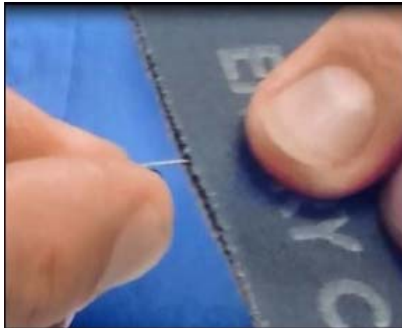
圖 10—使用砂紙清潔線圈
