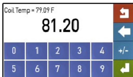
圖 30—線圈熱電偶校驗螢幕
